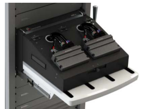
VPC 9025 TR с установленным испытательным устройством
