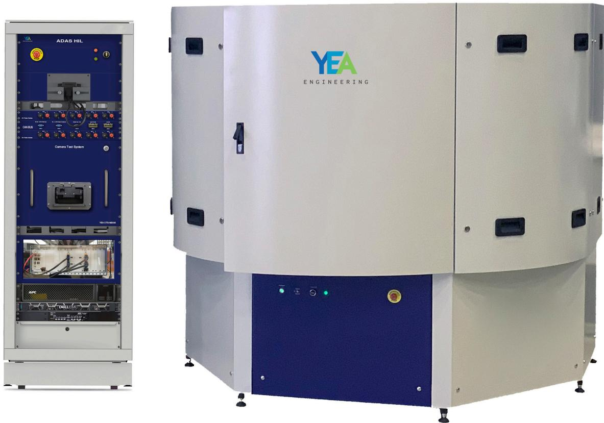
Платформа ADAS-HIL позволяет компаниям-производителям оборудования испытывать ADAS системы в контролируемой лабораторной среде, тем самым сводя к минимуму время и средства, затрачиваемые на реальные дорожные испытания.
